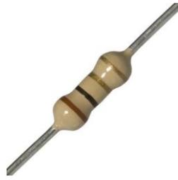
Resistência é a oposição que um corpo qualquer oferece a passagem de corrente elétrica. Essa oposição é dada pela sua estrutura atômica. Sabendo que resistência é uma característica, fica claro que não é correto chamar o resistor de resistência e vice-versa.
